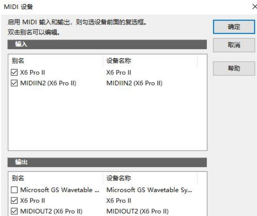
6. 在 **控制器/界面设置** 窗口，**输入端口** 和 **输出端口** 的下拉菜单中都选择 **X Pro II**，点击 **确定** 并关闭窗口
