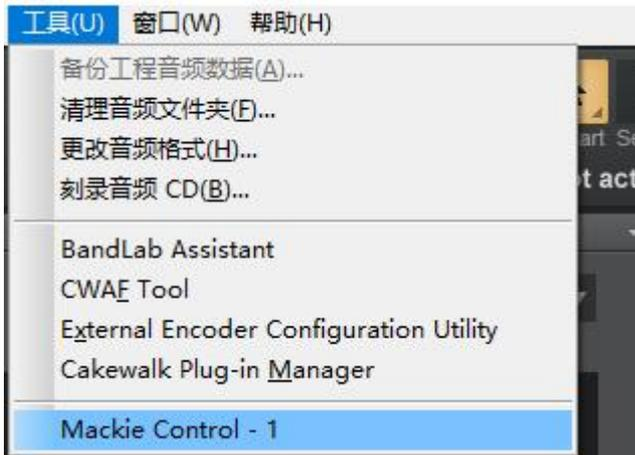
8. 在弹出的窗口的右侧勾选 **Options** 下面的 **Disable handshake**，关闭 Mackie Control-1 窗口，完成键盘设置
